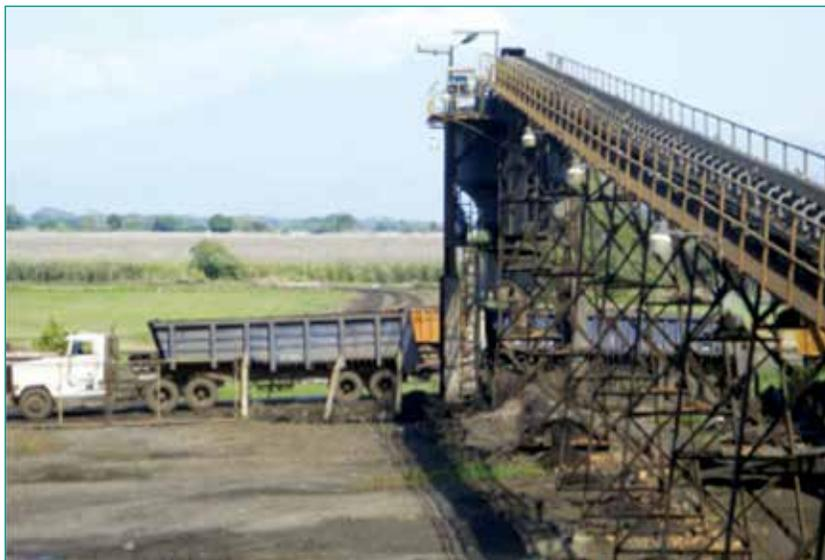
**Figura 1:** Un sistema de transporte de banda grande maneja los grandes volúmenes de cachaza que llenan camiones de volteo que se usarán para formar las hileras de cachaza.
