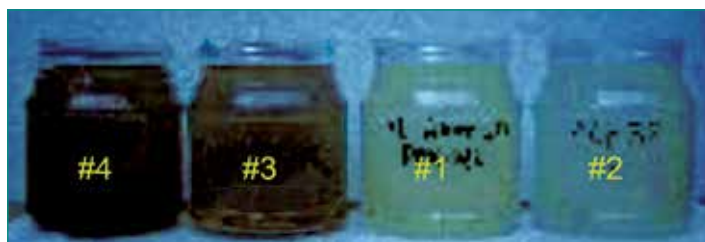
Figura3: Muestras de agua recolectadas después de 48 horas: la muestra del testigo es muy oscura y el agua está contaminada con heces (extrema izquierda); la muestra del tratamiento con el Producto K exhibe agua oscura (segundo de la izquierda); y muestras del tratamiento con ML están mucho más limpias (derecha).
